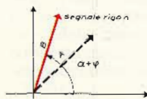
sulla schermo del ricevitore questo segnale alterato produce righe rosse e non porpora
