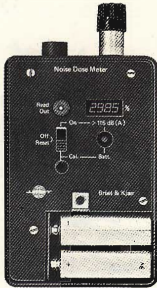
Fig. 21 - Dosimetro della Brüel & Kjaer per il controllo della esposizione al rumore di una singola persona, modelli 4424 e 4425.
