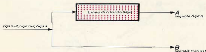
Fig. 60 - Sistema per poter disporre contemporaneamente dei segnali di crominanza della riga n e della riga n + 1 (che arriva 64 \mu s dopo). Il segnale di crominanza della riga n + 1 quando arriva sul punto B "trova" sul punto A il segnale di crominanza della riga precedentemente trasmessa (riga n ).
